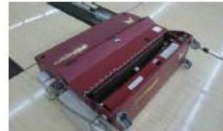
クーリング場の端のほうにおいてあるこの機械・・・いったいなにをする機械をご存知ですか？実はこの機械でレーン上にオイルをひいていきます。ただオイルをひくだけではなく、クリーニングしながらもともとひいてあったオイルを落としながら新たにオイルをひいていきます。機械の構造としては機械の前方でクリーナーを噴出させ中間部にはパキューームがセットされており、古いオイルとともにクリーナーを吸い込みます。そして機械後方でオイルをレーン塗布しています。
